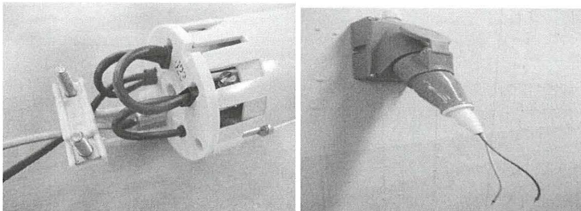
Подготовленные разъёмы соединяется с соответствующими разъёмами ЭУ. К полученным проводникам подключаются электроды мегомметра.
